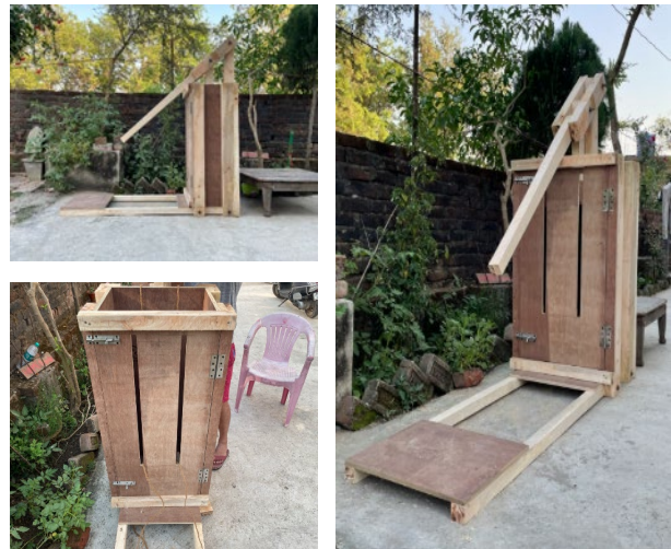
図3: 自作したストローベイル圧縮機
