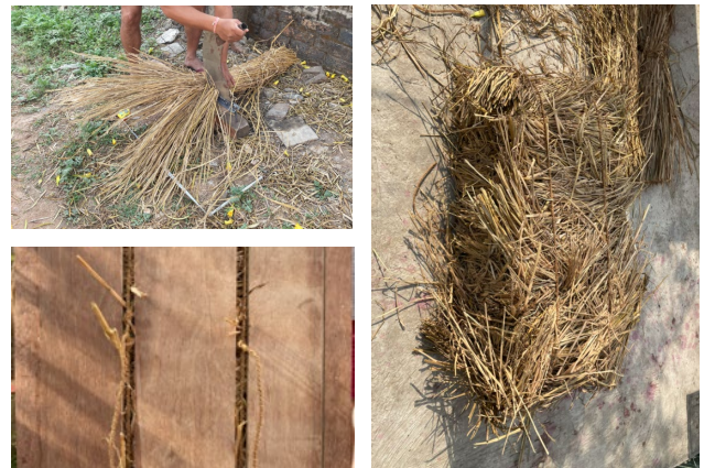
図4: 米藁を圧縮したストローベイル
